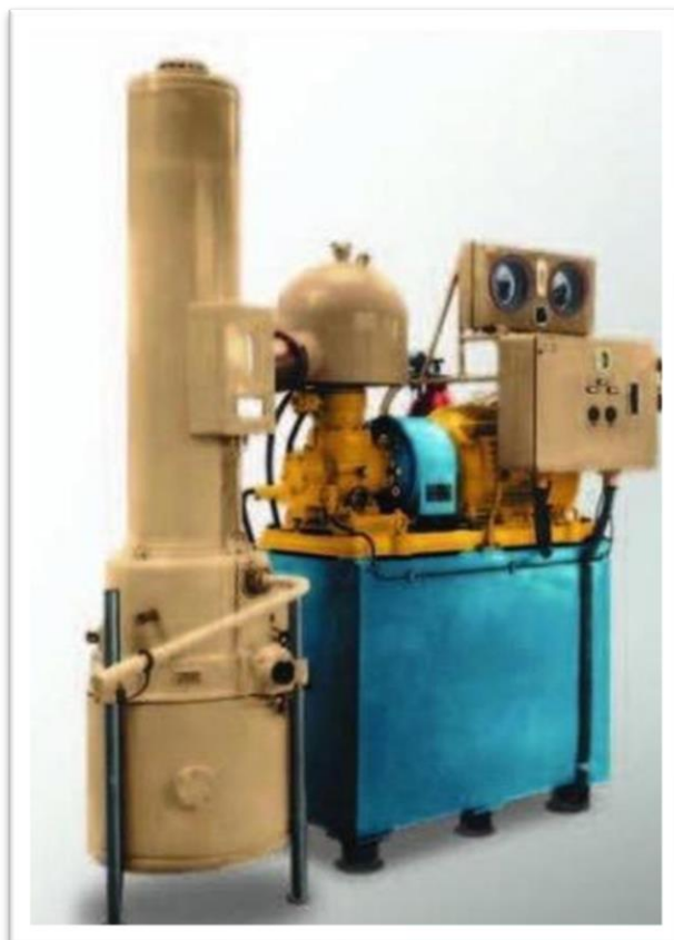
Liquid nitrogen production plant ZIF 1002
